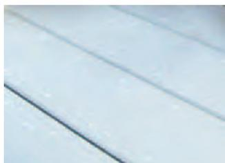
**Piano STANDARD:** è costituito da profili in alluminio rettificati e canali di scorrimento per il fissaggio meccanico dei pezzi.
