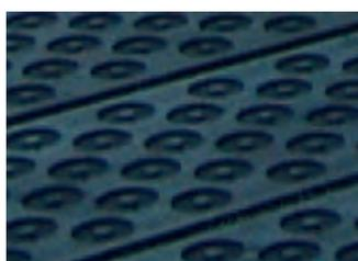
**Piano a TURBINA:** oltre al fissaggio meccanico dei pezzi tramite guide, è equipaggiato con apposite valvole installate sulla struttura macchina, che permettono la selezione a zone dell'aspirazione.
